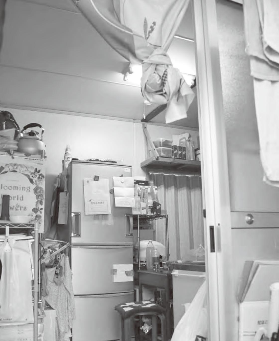
仮設住宅の部屋は、ドアを開けるとすぐにキッチンとリビング、奥に4畳ほどの部屋が2部屋と風呂、トイレという間取りです。そこに親夫婦・子ども夫婦・孫の3世代が同居している世帯もあります。柱と壁の隙間には入居時からビニールテープのようなものが貼られており、とても簡単な造りに見えます。プレハブの壁は冷たく、発泡スチロールの板をはさむなどで寒さ・暑さ対策や、虫の侵入を防ぐ対策をしなくてはなりません。
