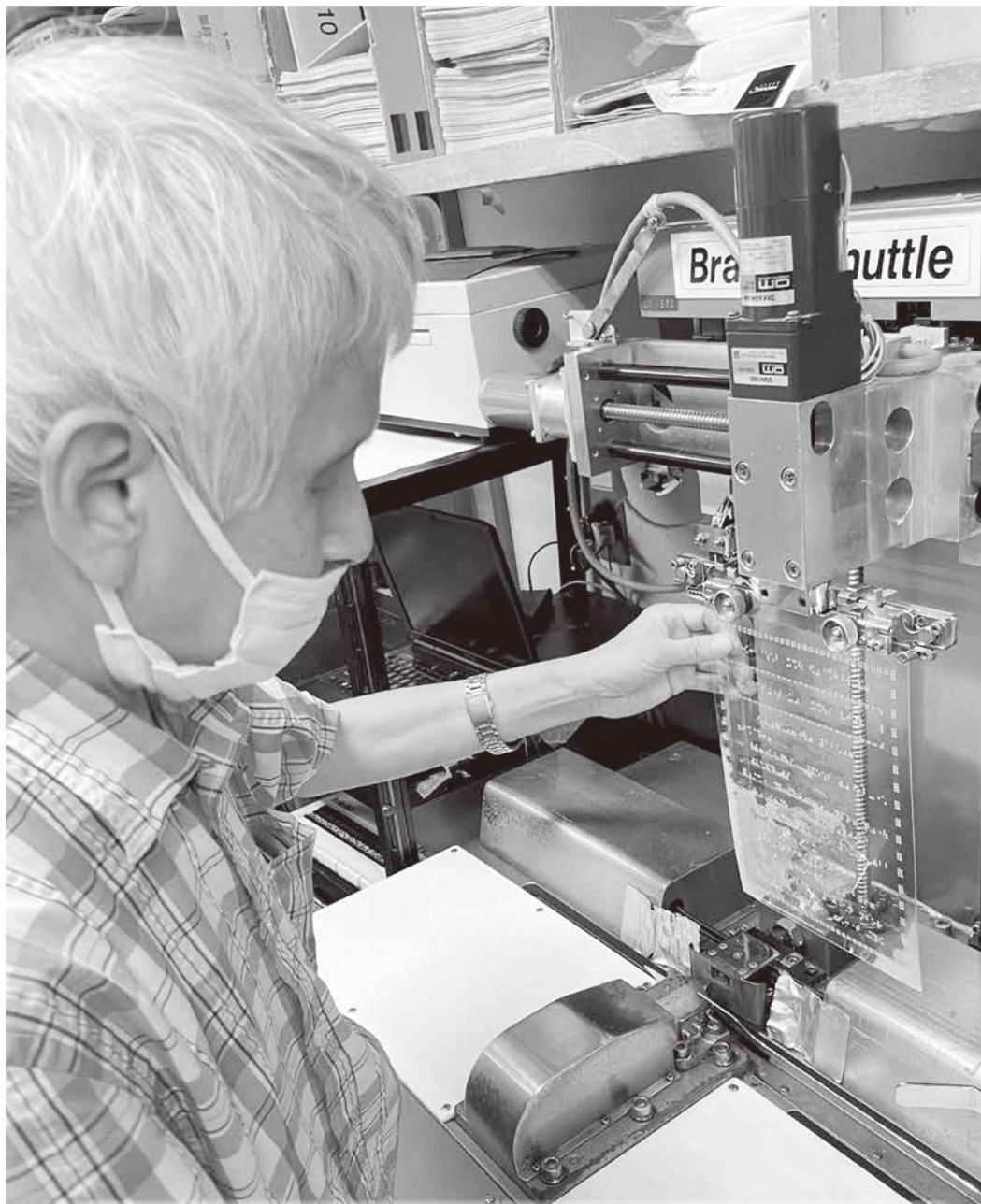
点訳データを点字プリントし、触読しながら校正したのち、製版です。点訳データを、点字製版機でプラスチック板に製版します(写真)。その後、再度製版した原板で声出し触読により校正作業をおこない、いよいよ印刷です。原板に用紙を挟んで機械で圧を加えると、原板の点字が紙に印字されます。それを検品・製本して、やっと点字版『福祉のひろば』の完成です。点字版『福祉のひろば』は240ページとなり、厚みは小さな辞書1冊分ほど。読み上げた音声データは、全部で4時間半ほどになるそうです。
